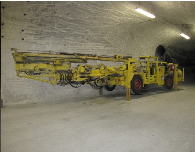
Bohrlafette für die Sprenglöcher
